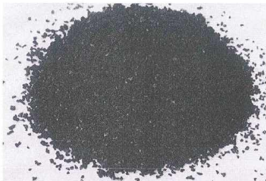
Hình 18. Than hoạt tính sử dụng trong HTXLKT tập trung
