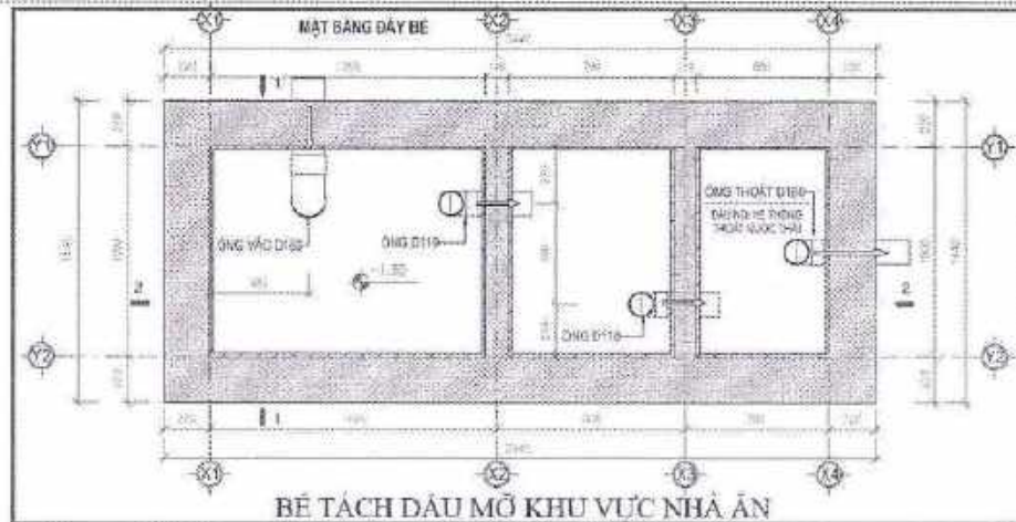
Hình 15. Bể tách dầu mỡ khu vực nhà ăn
