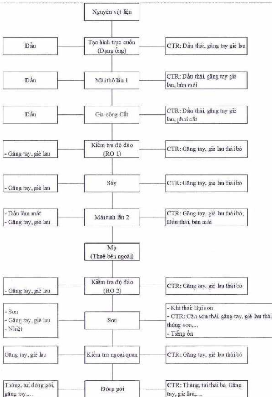
Hình 5. Sơ đồ công nghệ sản xuất trục cuộn giấy dạng ống
