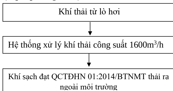
Hình 3.7. Sơ đồ thu gom, thoát khí thải của cơ sở
