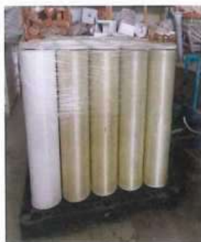
Màng lọc thẩm thấu ngược RO của hệ thống xử lý nước sạch trước khi rửa
