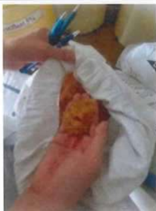
Hạt nhựa trao đổi ion của hệ thống xử lý nước sạch, nước siêu sạch của Khách hàng trước khi hoàn nguyên
