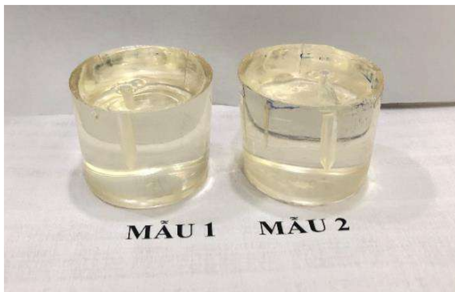
Hình 3: Hình ảnh mẫu nhựa PEKN sau khi đóng rắn (ở 2 mẻ thử nghiệm khác nhau)
