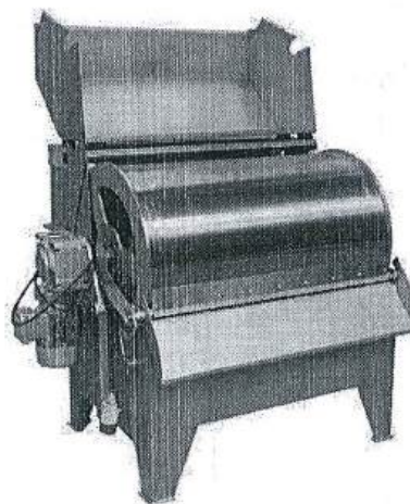
Hình 4.5. Thiết bị tách rác kiểu trống quay
