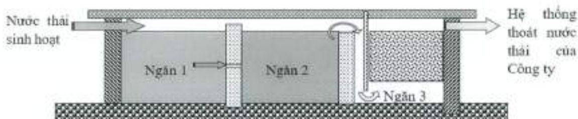
Hình 5: Sơ đồ xử lý sơ bộ tại bể tự hoại 3 ngăn
